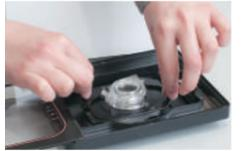
采用弹簧性阻尼设计，万一物镜和培养皿底部干扰，可防止培养皿和物镜的损坏。
